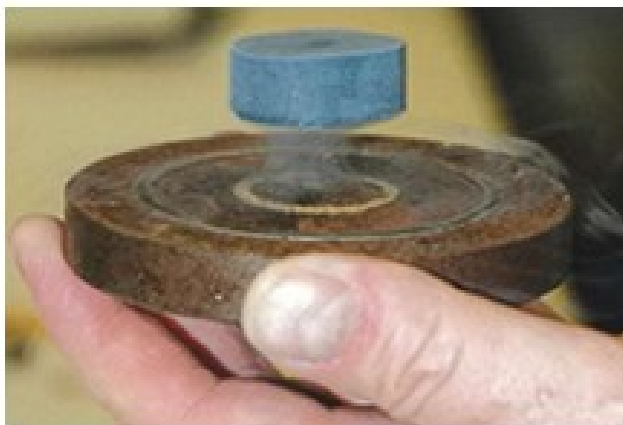
Gambar 6. Superdiamagnetik levitasi superkonduktor {sumber: www.cam.ac.uty}
